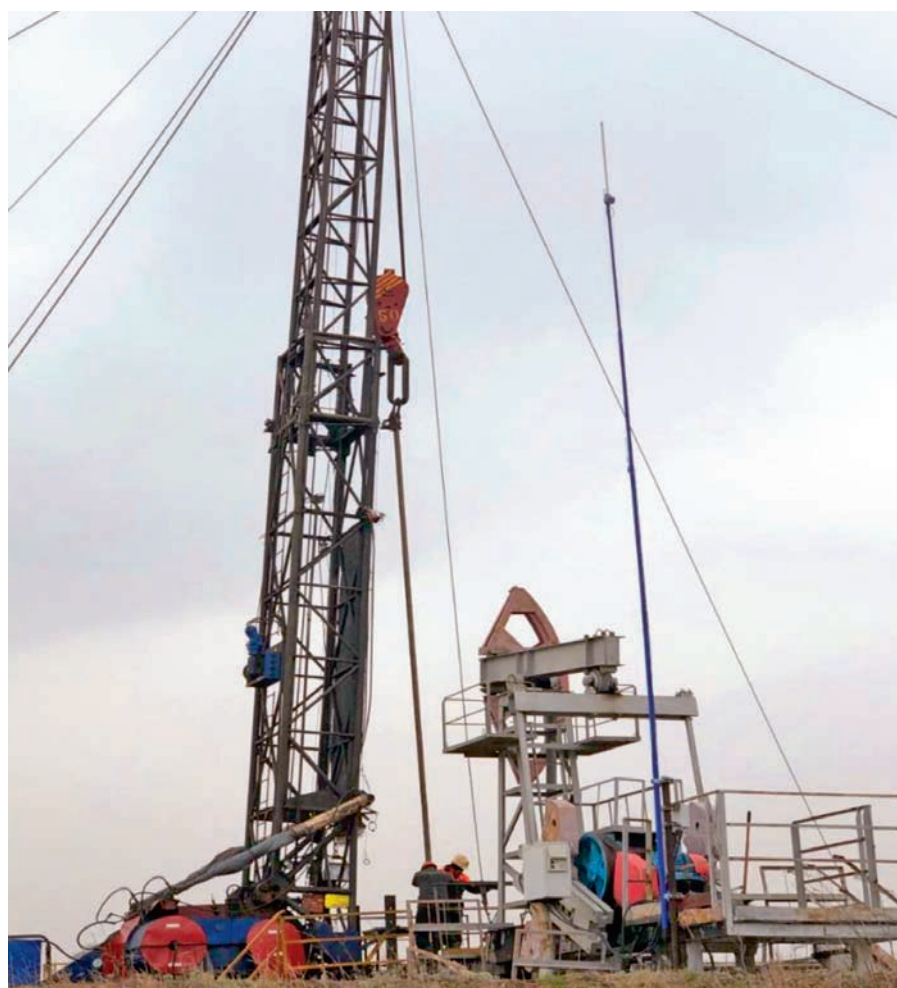
Рис. 2. Полевые испытания колонны насосно-компрессорных труб с теплоизоляционным полимерным покрытием «Шельф-термос» на устье скважины № 228 Коробковского месторождения
