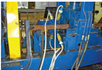
Рис. 1. Монтаж излучателей на станке Fig. 1. Installations of emitters on-machine
